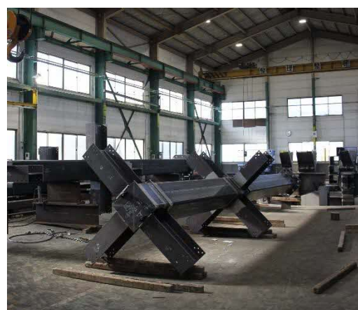
<溶接された柱>
